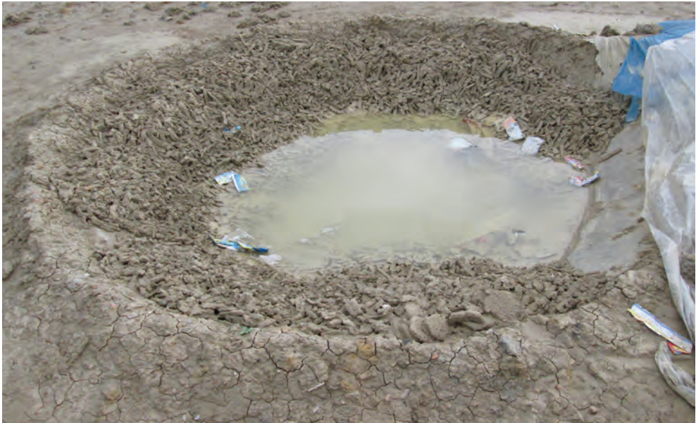
Fig. 3. Fosse ( zūba ) destinée au trempage de l'argile servant à la fabrication de la brique, du zellij et de la poterie : Nouveau quartier d'al-Fakhārīn à Meknès. (al-Rmīka) (cliché : A. El Khammar)
