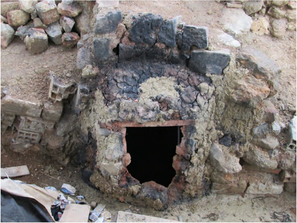
Fig. 6. Vue de la partie inférieure d'un four de zellij ( sjan ) : Nouveau quartier d'al-Fakhārīn à Meknès (al-Rmīka) (cliché : A. El Khammar)
