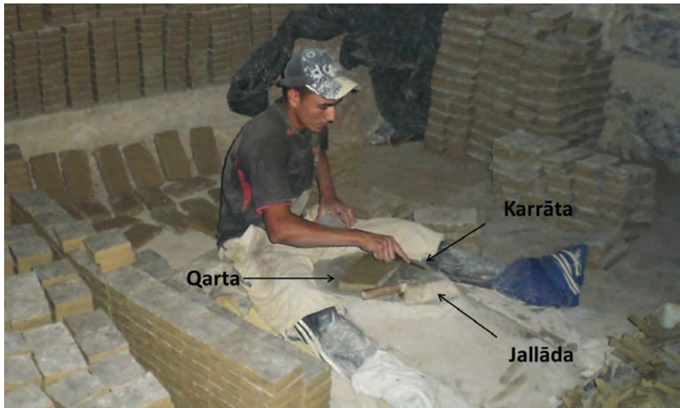
Fig. 4. Un jeune apprenti fabrique des pièces rectangulaires de zellij ( bajmāt ) : Il se sert de la qarta , de la jallāda , du qāla et de la karrāta (nouveau quartier d'al-Fakhārīn à Meknès : al-Rmīka) (cliché : Archives)
