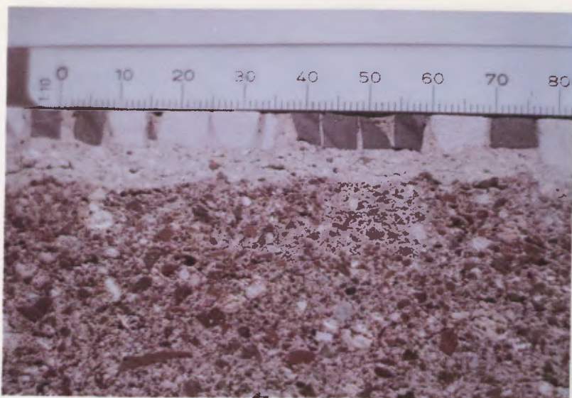
Fig. 3.- Sección de mosaico donde se aprecian los distintos tamaños y formas de las teselas. En la solera se ven fragmentos cerámicos.
