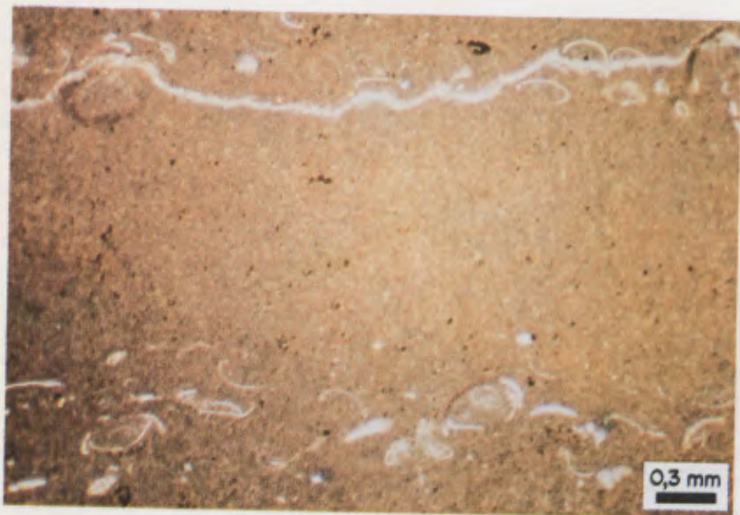
Fig. 6.- Fotomicrograria de una tesela gris, caliza con alineaciones defósiles . Mosaico de las Copas, Alcalá de Henares.
